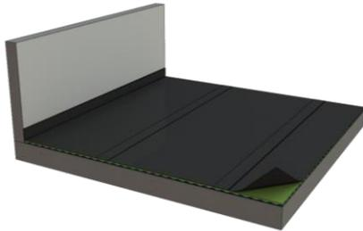
**7)** (Optionnel) Poser un polyane (0,2 mm) avec un chevauchement d'env. 20 cm avec les jonctions des matelas. Sur les côtés, le polyane dépassera d'environ 15-20 cm le niveau du plancher fini.
