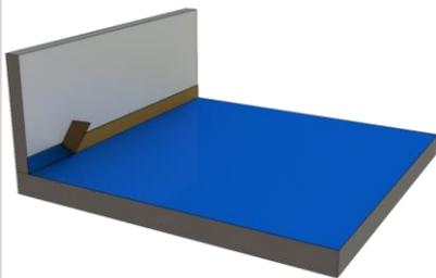
**4)** Coller en bas des murs et sur les montants des bandes de remontées latérales.
