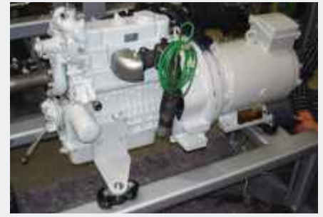
Petite centrale de cogénération sur Isotop DMSN-BL (exécution spéciale)
