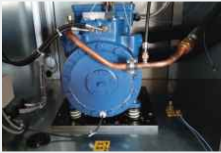
Compresseur à piston avec Isotop DMSN
