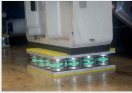
Pied d'une machine textile sur Isotop DMSN-BL (version spéciale)
