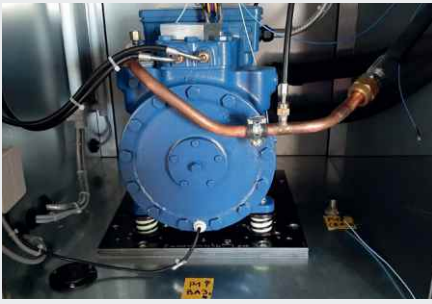
Compresseur à piston avec Isotop DMSN
