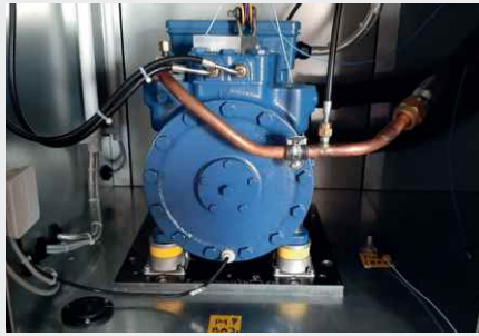
Isolation d'un compresseur à piston avec Isotop DZE Mini
